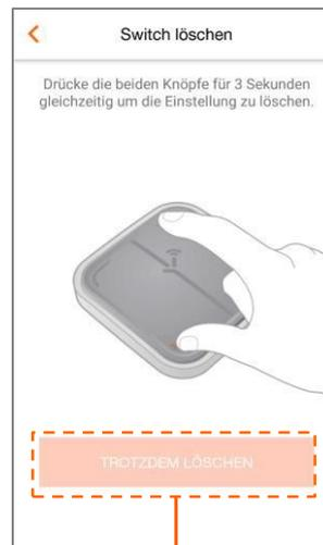
2. Drücken Sie die beiden Tasten des Switch und tippen Sie auf „Trotzdem löschen“.
