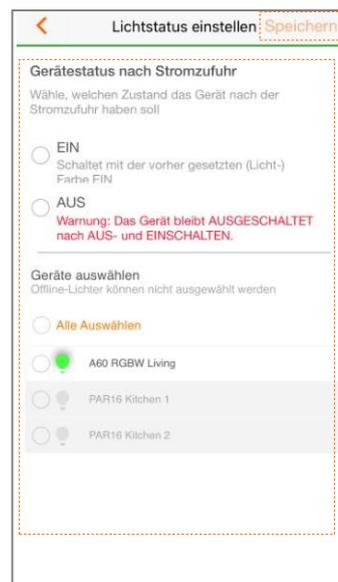
Wählen Sie aus welchen Zustand das Gerät nach einer Stromzufuhr haben soll. Wählen Sie im unteren Bereich noch aus für welches Geräte diese Änderung gelten soll und klicken Sie auf „Speichern“ um die Einstellung zu sichern.
