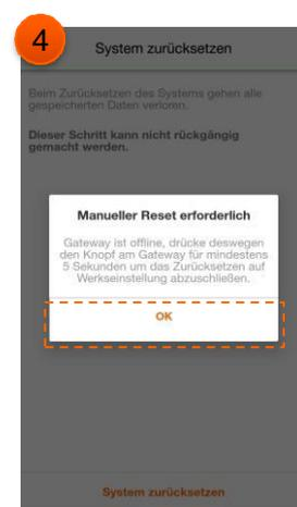
Ist Ihr Gateway bei diesem Schritt offline, müssen Sie das Gateway manuell resetten.
