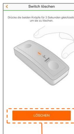
2. Drücken Sie die beiden Tasten des Switches und tippen Sie auf „Löschen“
